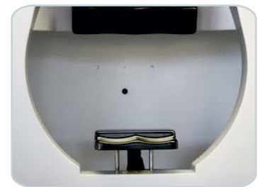
Fixationspunkt, darunter Digitalkamera, Kinnstütze elektronisch verstellbar.
