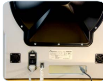
Rückseitige Anschlüsse: Netz, Antworttaste, USB.
